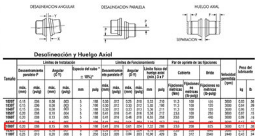
Figura 3. Límites de funcionamiento del acoplamiento utilizado.
